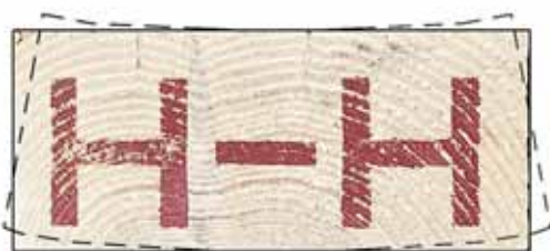
Kuva 5. Puun sydämeen päin ollut laudan lape on sydänpuoli. Jos lauta saa liikkua vapaasti, se voi hieman kupertua: vuosirenkaat pyrkivät oikeenemaan
